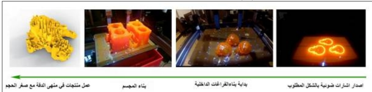
شكل (١١) مراحل بناء مجسم باستخدام تكنولوجيا DLP (٢١)
